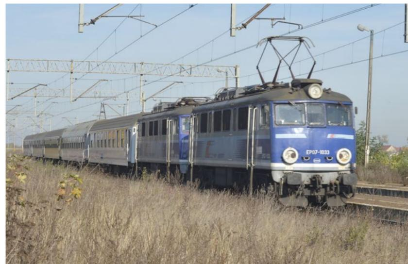
**Fünf Wagen und eine leerlok sind für EP07-1033 keine große Anhängelast. Im Oktober 2013 passierte diese Garbitur in Diensten der PKP Intercity den Bahnhof Lipno. Als Schnellfahrloks erhielten die EP07 neue Stromabnehmer mit Doppelschleifleisten.**
