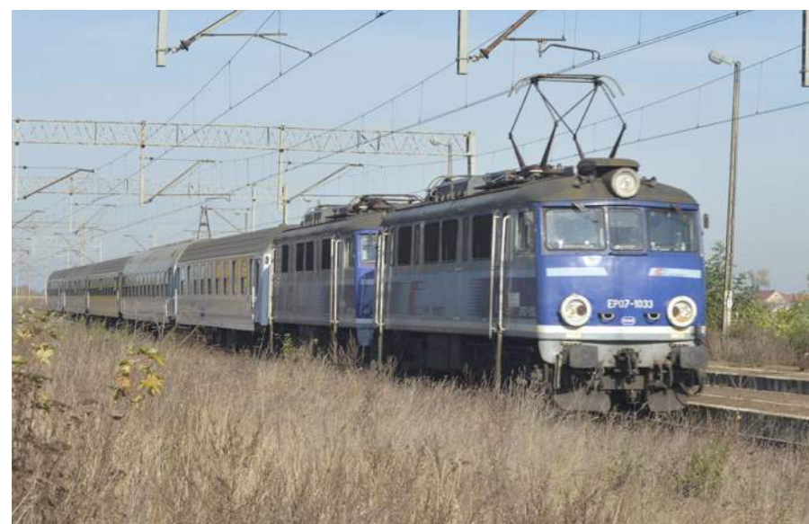
Pięć wagonów i siostrzana lokomotywa są dla EP07-1033 niewielkim obciążeniem. W październiku 2013 r. pociąg przejeżdża stację Lipno. Ta lokomotywa ma aktualne malowanie ICC dla pociągów Intercity. Przy przebudowie na EP07 zlikwidowano typowe dla czołowej ściany lokomotywy gniazda sterowania wielokrotnego i wielką komorę sprzęgu.
