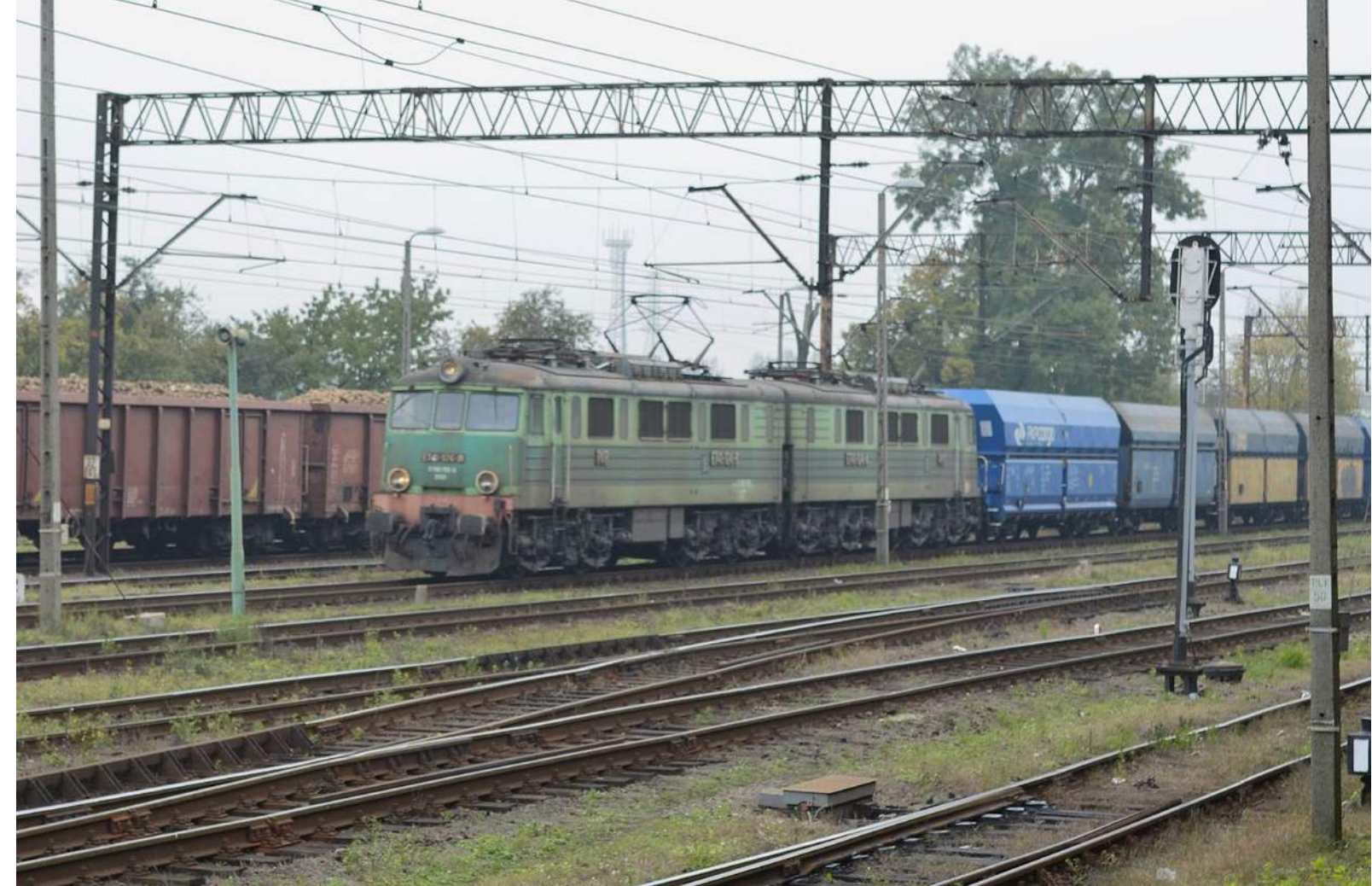
Do obsługi ciężkich składów towarowych, PKP zakupiło ciężki elektryczny ET41, złożony z dwóch jednostek EU07. Fot. (Raciborz): Robert Reschka
