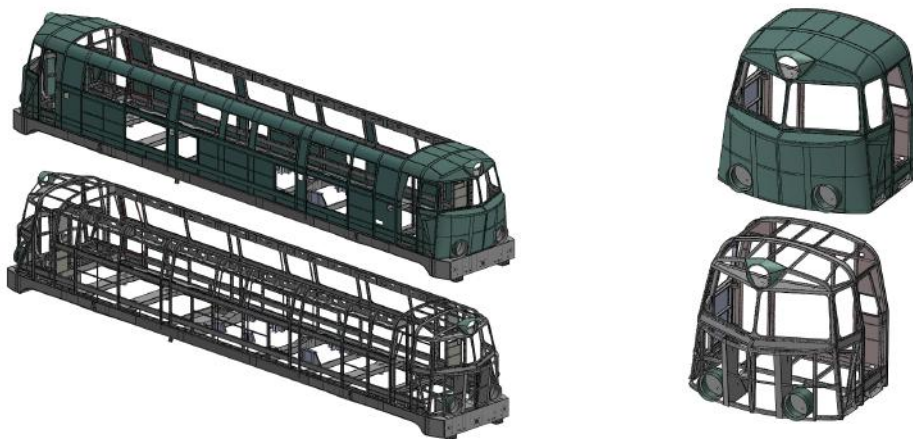
Rys. 7. Widok na model szkieletu pudła i kabiny (z poszyciem oraz bez) lokomotywy 301Dd (SU45) przed modernizacją
