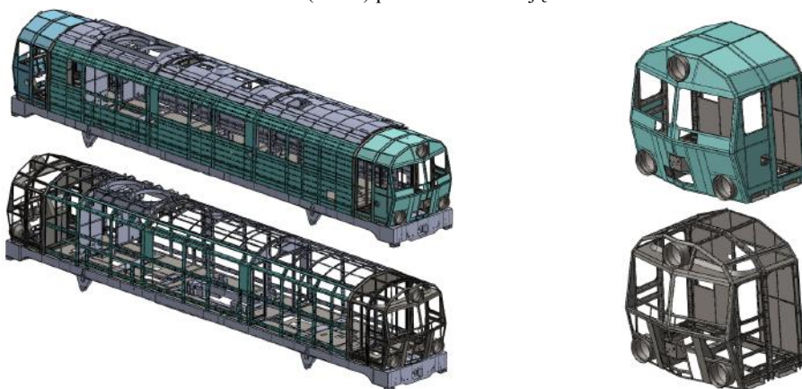
Rys. 7. Widok na model szkieletu pudła i kabiny (z poszyciem oraz bez) lokomotywy 301Dd (SU45) przed modernizacją
