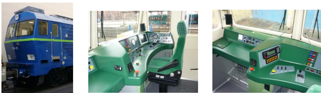
Rys. 23. Widok lokomotywy 303D (ST46) oraz kabiny po modernizacji z nowymi stanowiskami sterowniczymi
