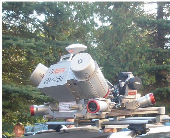
Rys. 7. System VMX-250 z dodatkowymi kamerami Nikon 700
